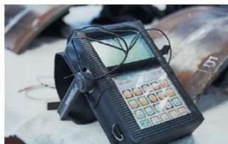
В ООО «Газпром трансгаз Екатеринбург» используется четыре модели ультразвуковых дефектоскопов, самая распространенная — «Пеленг УД 2-102»
