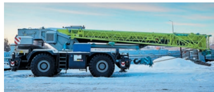
Кран оснащен телескопической стрелой длиной 45 м
