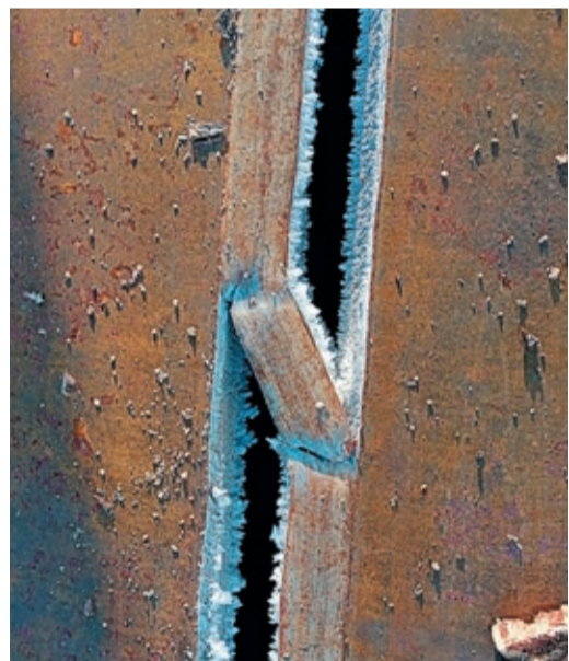
Трубу из стали К80 разорвало, когда давление воды достигло 360 атмосфер
