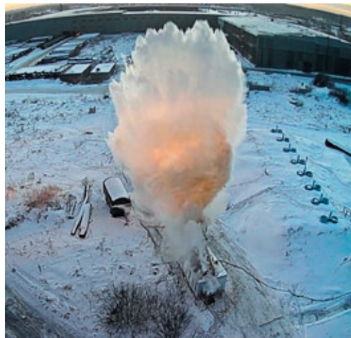
Когда наступил предел прочности металла, в небо ударил многометровый фонтан
