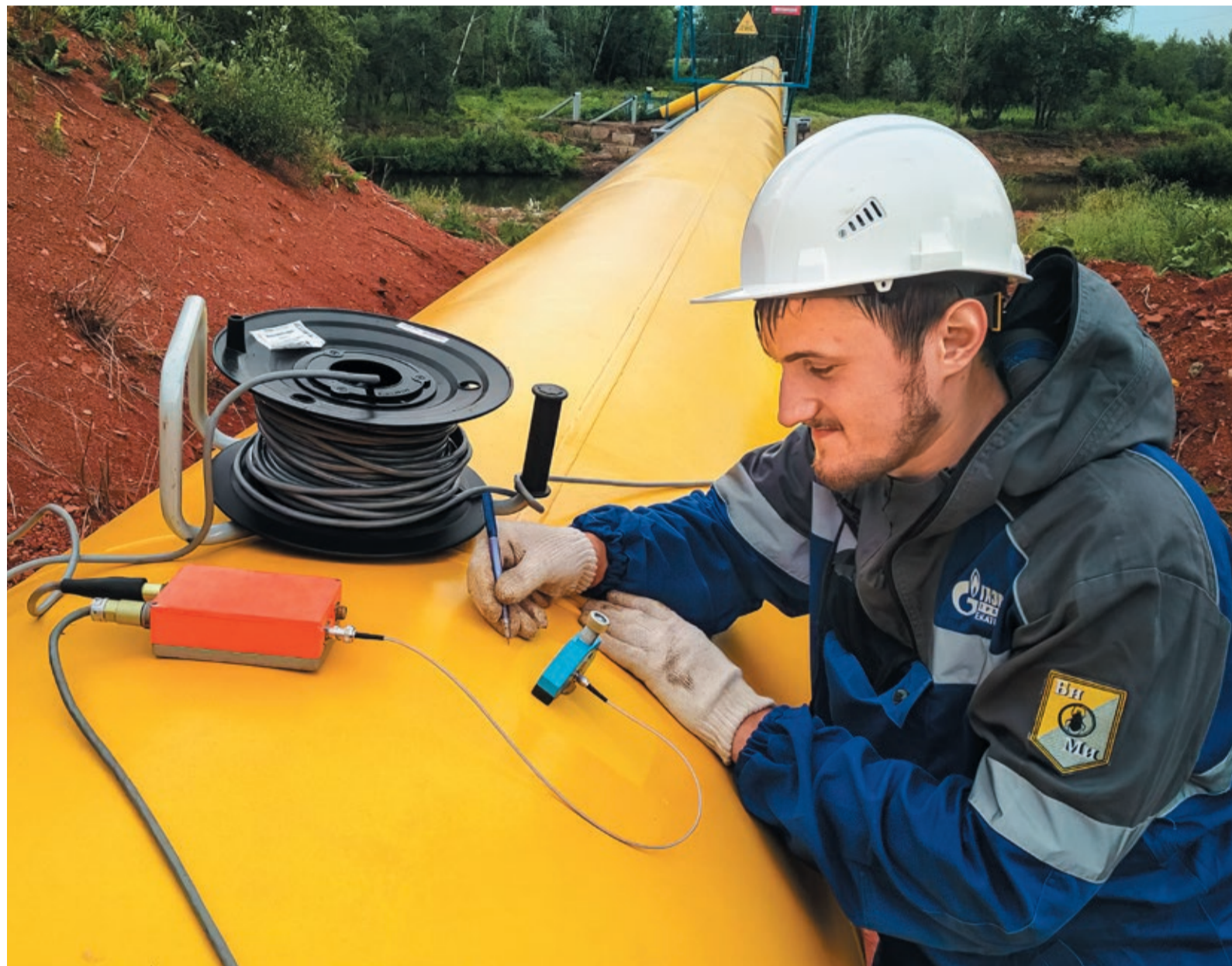
Для обследования сложных переходов инженер службы неразрушающего контроля ИТЦ Никита Кунцевич и его коллеги использовали метод акустической эмиссии
