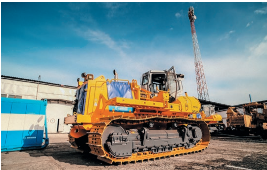
В УАВР № 2 получили пару трубоукладчиков ТГ 35.80 — самых мощных из всей линейки: когда навесят стрелу, каждый сможет поднимать до 50 тонн груза
