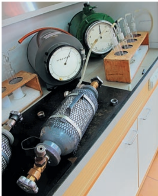
В лаборатории Оренбургского филиала газовые пробы разбирают на молекулы химическим способом и с помощью хроматографа
