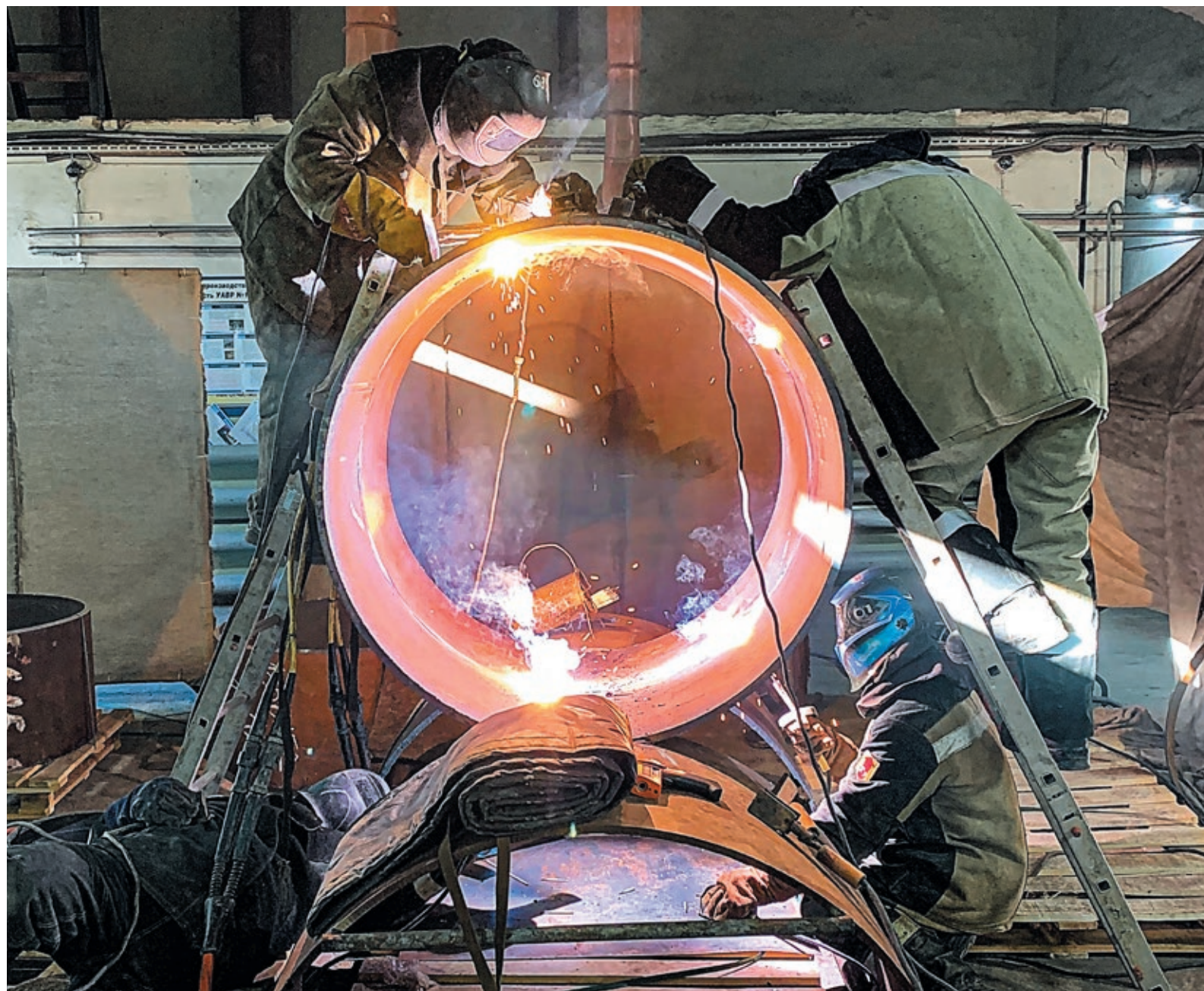
Чтобы совладать с новой трубой, сварщики пять месяцев варили допускные стыки
