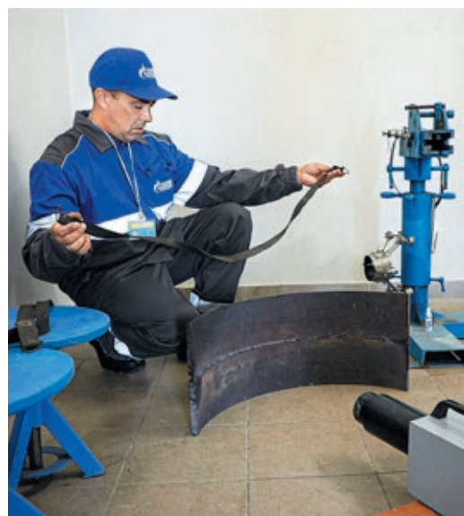
Рентгенаппарат готов к работе, осталось закрепить кассету с пленкой
