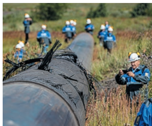
Сила сжатого воздуха разорвала трубопровод на части (слева направо): одна плеть сделала «свечку», другая улетела на десятки метров, центральную катушку скожкала, как лист бумаги
