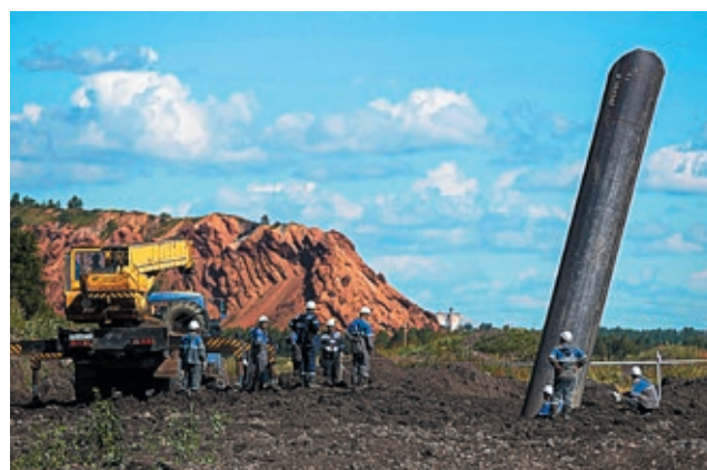
Сила сжатого воздуха разорвала трубопровод на части (слева направо): одна плеть сделала «свечку», другая улетела на десятки метров, центральную катушку скожкала, как лист бумаги
