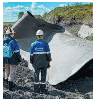
Сила сжатого воздуха разорвала трубопровод на части (слева направо): одна плеть сделала «свечку», другая улетела на десятки метров, центральную катушку скожкала, как лист бумаги
