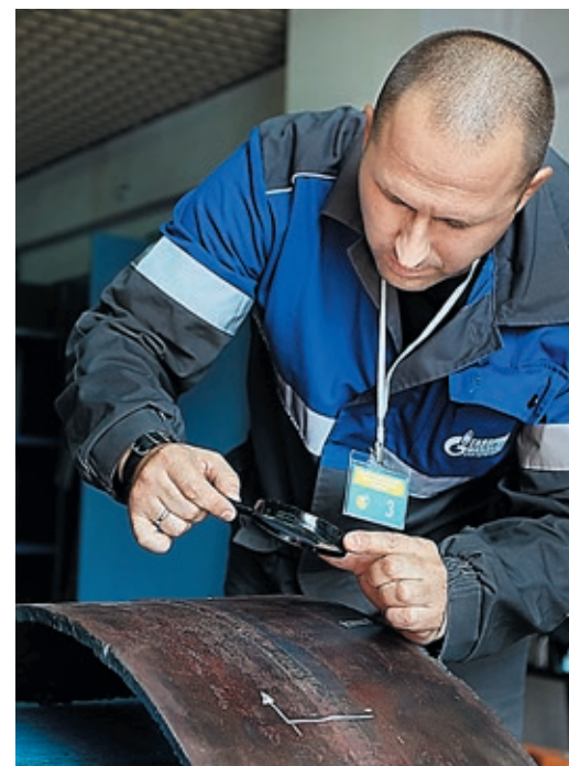
Михаил Теплов исследует внешние дефекты стыка — еще один шаг на пути к победе
