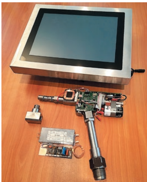
Заправочный пистолет оснащен электронными платами третьего поколения
