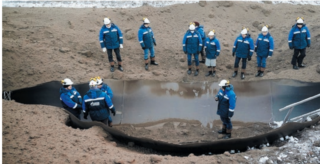
Главная интрига любых испытаний — как далеко ушла трещина от эпицентра взрыва
