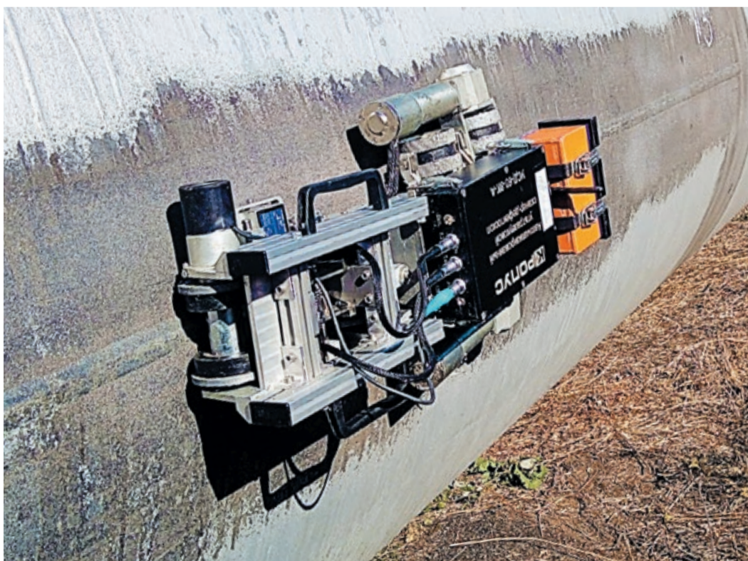
Диагностический «поезд» на магнитных колесах движется по специально расчищенной дорожке
