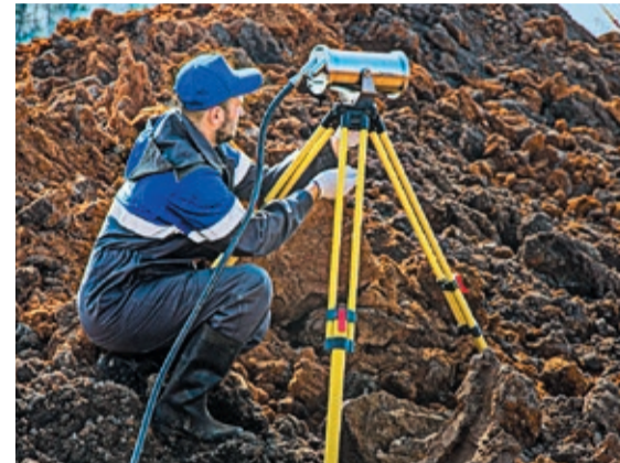
Взрывозащищенные видеокамеры для видеофиксации огневых и газоопасных работ
