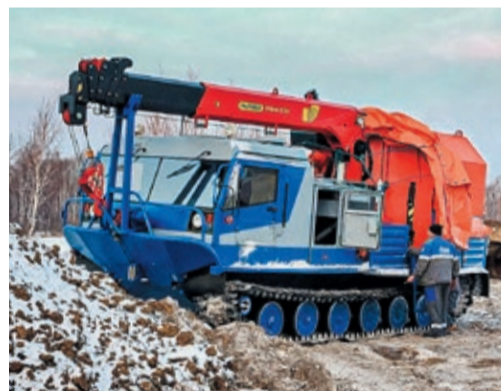
Мобильный сварочный комплекс на базе гусеничного вездехода ТМ-140П
