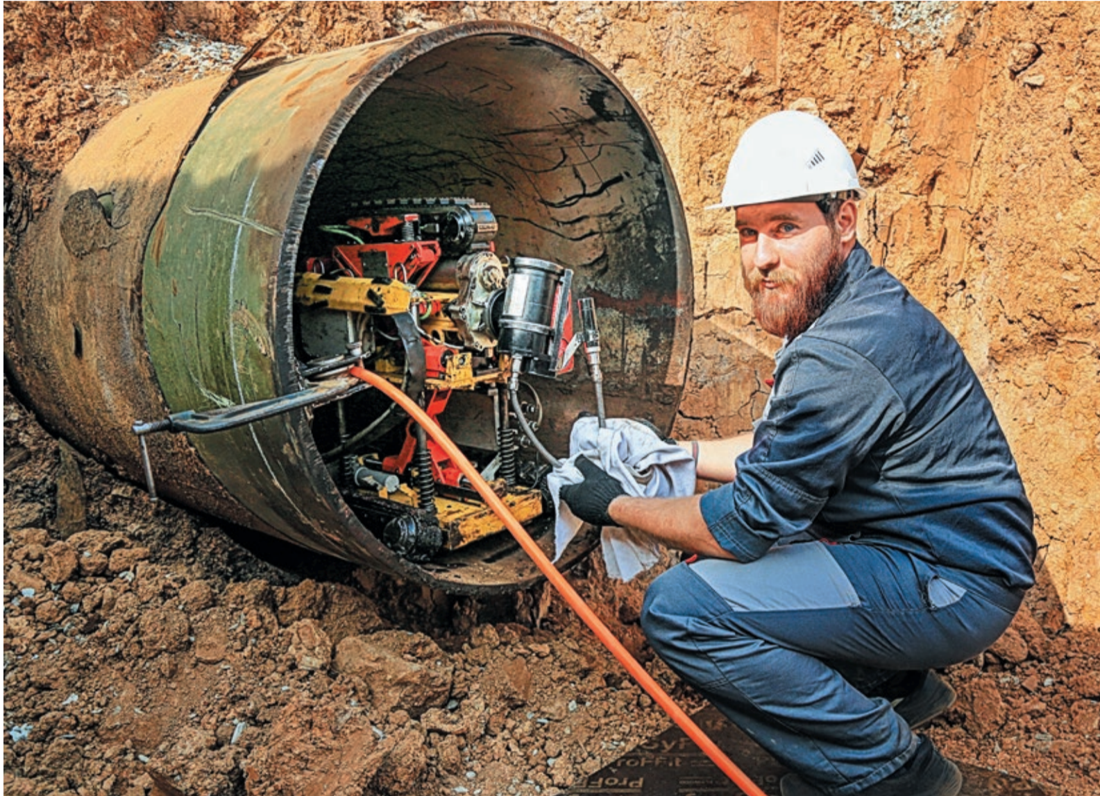
Трубопроводы на компрессорных станциях обследуют специалисты подрядной организации: они подводят робота к выходу, чтобы заменить диагностический модуль или протереть от пыли ходовые камеры и объектив оптической насадки
