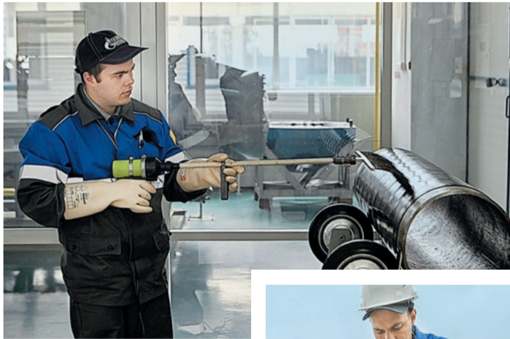
По программе конкурса специалисты искали пробой изоляции...
