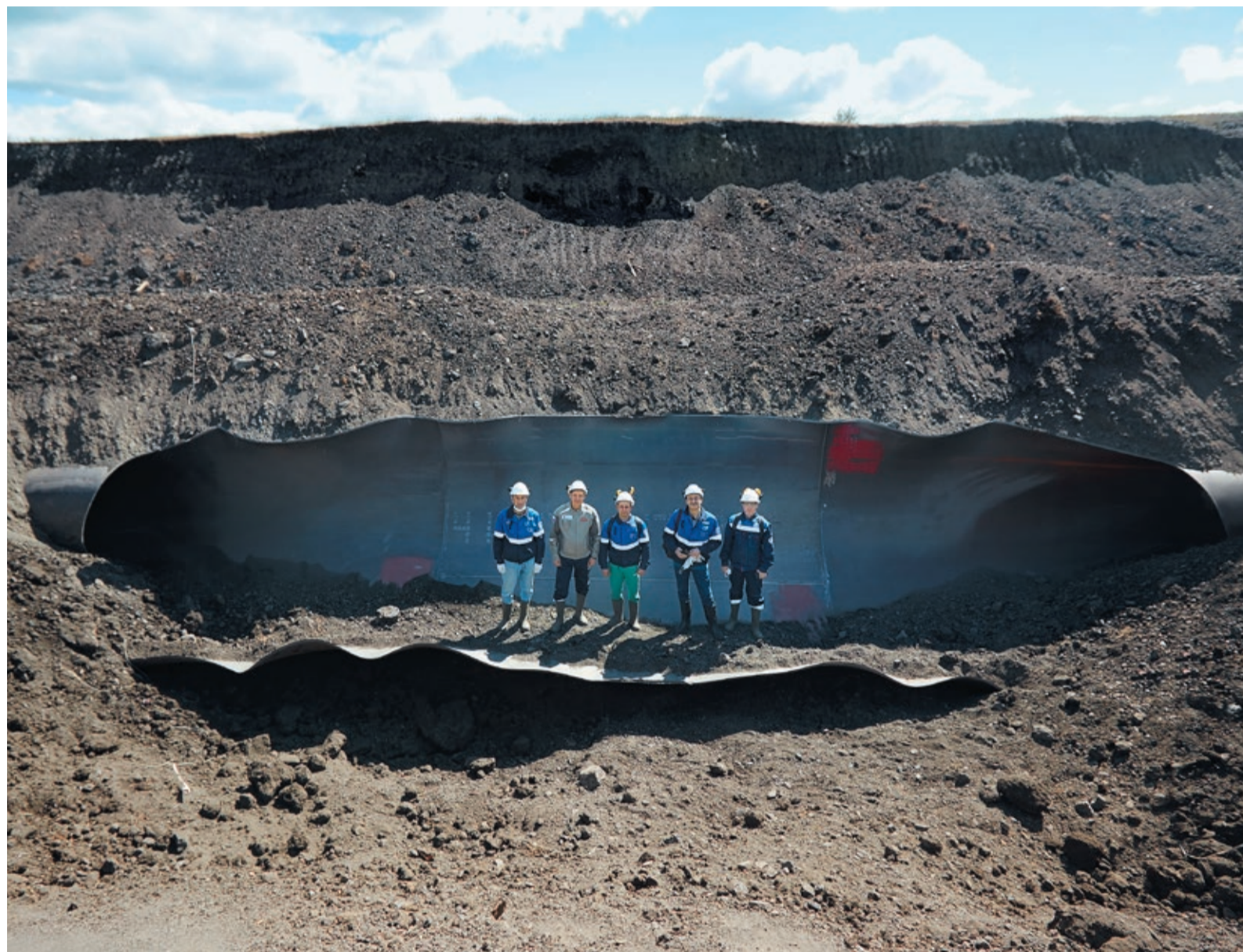
От взрыва катушка-инициатор раскрылась, как лист бумаги, но большая часть трубопровода устояла
