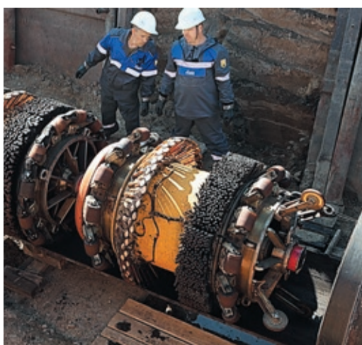
Вначале колесный робот пробрасывал трос, а затем с его помощью на другой берег протягивали внутритрубные поршни
