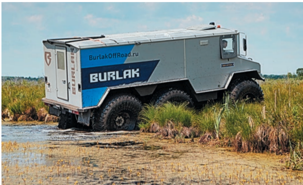
На машине стоят шины низкого давления, их подкачивают и подпускают насосом прямо на ходу
