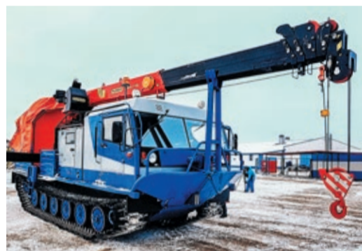
Проходимость вездехода улучшена за счет широких резино-металлических гусениц, оказывающих минимальное давление на грунт
