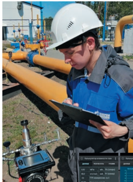
Никаких звонков и бумажных таблиц! Измеряем влажность газа и... дальше думает Android
