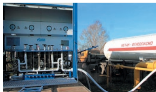
Во время огневых работ голубое топливо подают потребителям из криоцистерны: из жидкого состояния оно возвращается в газообразное, пройдя через мобильную регазификационную установку
