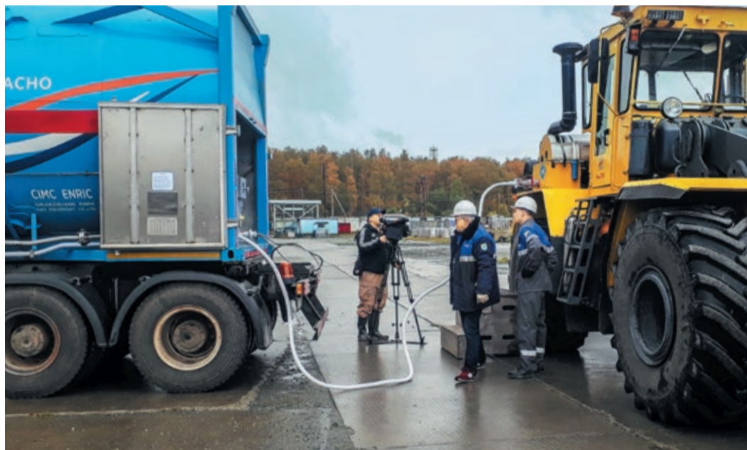
Заправляют трактор методом передавливания, и длится заправка менее получаса
