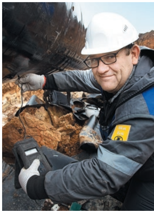
Для поиска КРН нужны дефектоскоп, белая краска и магнитный порошок
