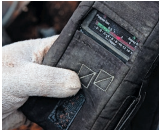
Вихревой дефектоскоп показывает глубину трещин в металле
