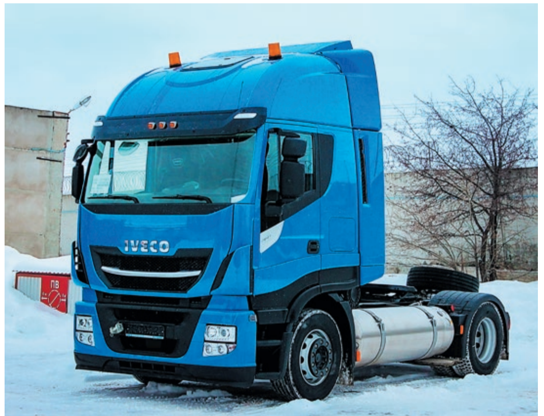
По бокам у седельного тягача IVECO Stralis — два криогенных бака, поэтому без дозаправки он способен пройти полторы тысячи километров
