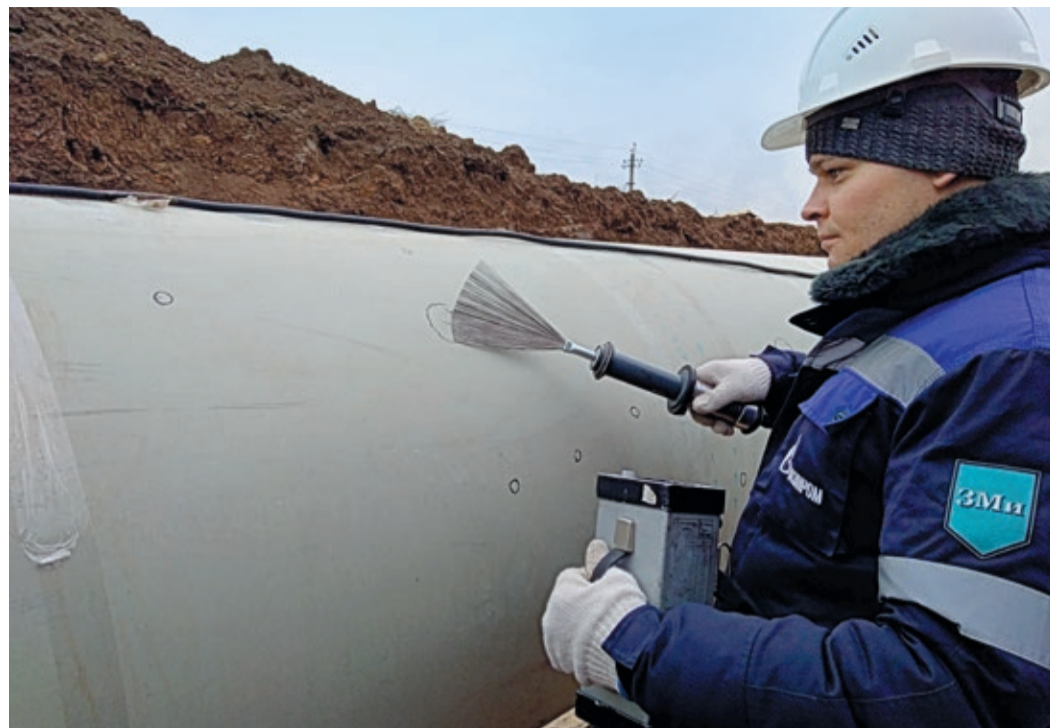
С искровым дефектоскопом можно обнаружить даже крохотные трещины в защитном покрытии
