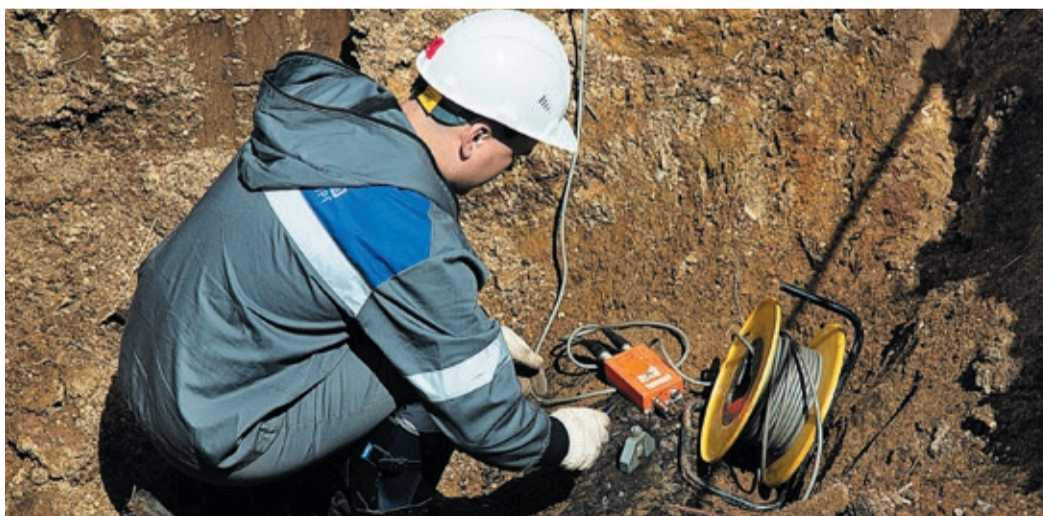
Для настройки аппаратуры проще всего сломать об трубу грифель карандаша
