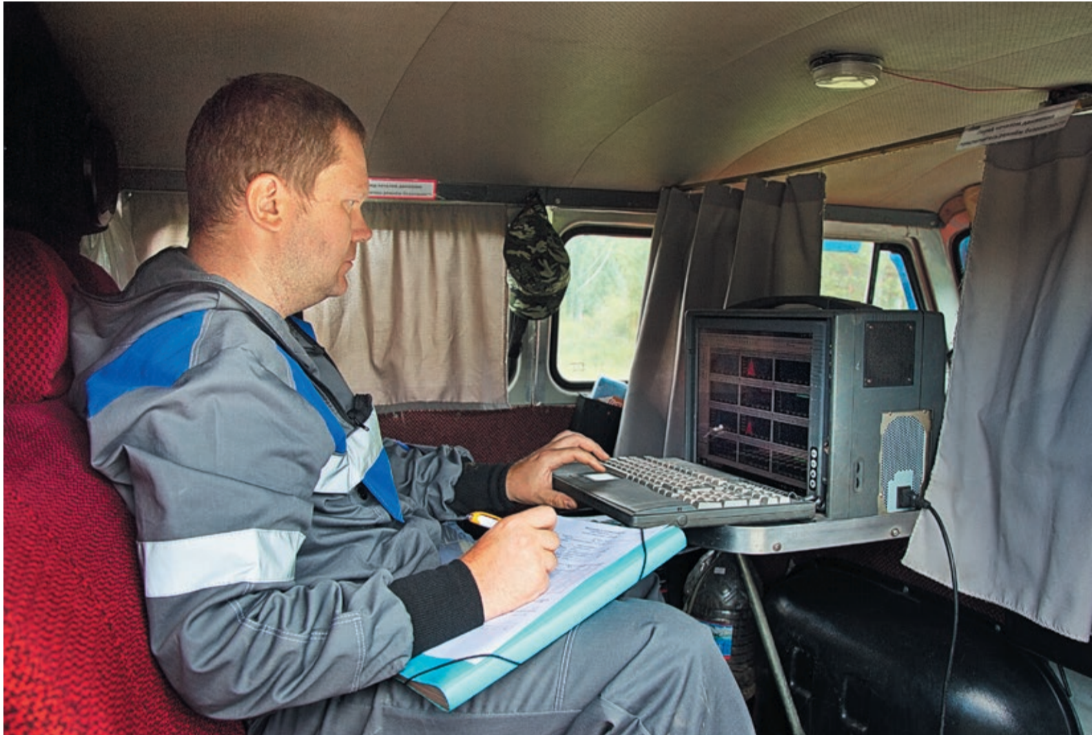
С помощью специальной аппаратуры Алексей Телегин может уловить звук нарождающейся трещины
