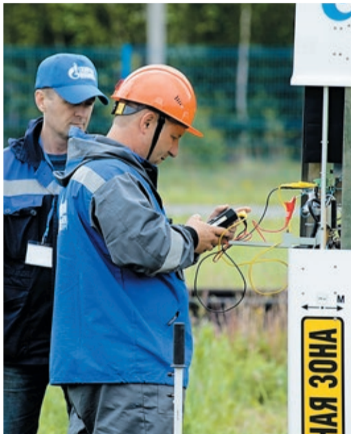
Защитники трубопроводов проверили диэлектрическую сплошность покрытия, измерили защитный потенциал и разобрались с фирменными цветами
