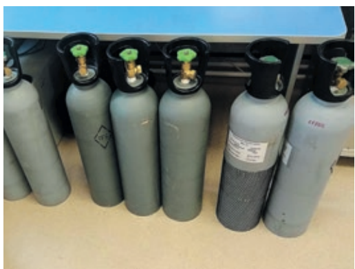
После аттестации на эталоне газ в баллонах становится «стандартным образцом»
