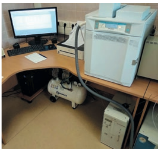
Оборудование эталона разместили в Уральском региональном метрологическом центре, в его состав входят хроматограф, приборы для измерения влажности, атмосферного давления и других параметров
