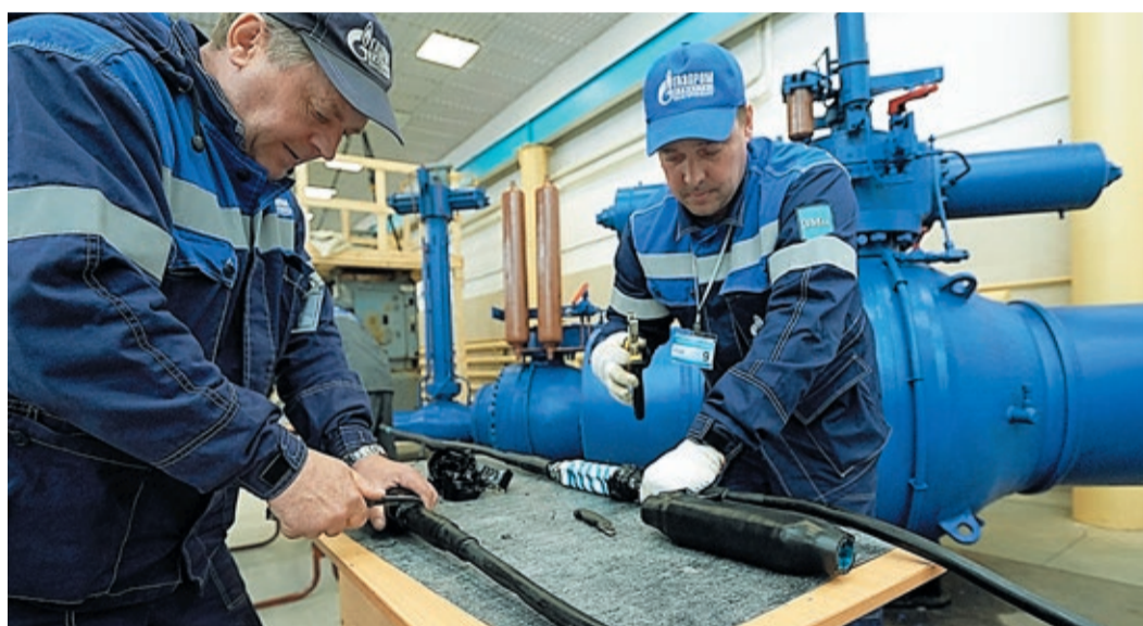
Для проверки качества сборки муфту срезают и разбирают все соединения
