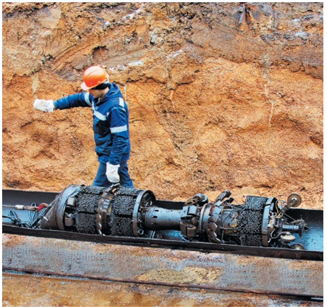
Финишировавший дефектоскоп выкатывают на приемный лоток, где с него, первым делом, скачают все собранные данные
