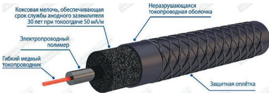
Протяженный гибкий анод имеет сложную многослойную структуру
