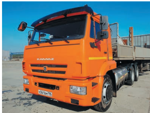
Один из опытных образцов «КамАЗа», работающих на СПГ, проходит испытания в УАВР-3 «Газпром трансгаз Екатеринбург»
