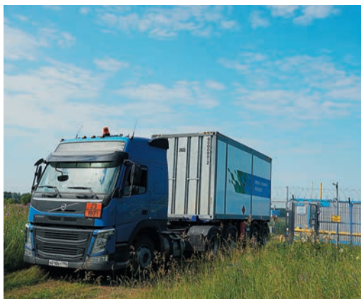
Пока газораспределительная станция была подключена к ПАГЗу, ремонтники успели устранить дефекты, вырезать тройник и поменять краны
