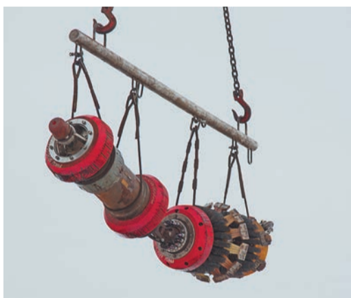
Внутритрубный дефектоскоп способен за один раз «просветить» десятки километров газопровода
