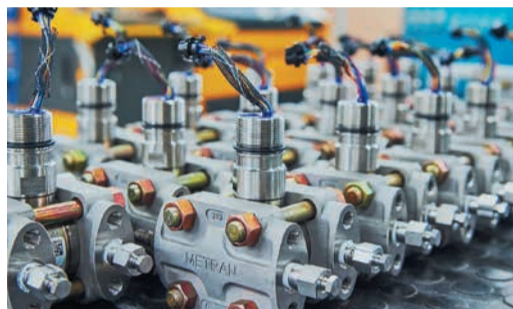
Работа над датчиками «Метран» начинается с изготовления главного элемента — измерительного модуля. Цикл производства составляет около пяти дней: один уходит на сборку и заполнение силиконовым раствором, остальные — на проверку, «тренировку» и тонкую метрологическую настройку. Примерно 50% комплектующих, включая электронные компоненты, поступает из России.
