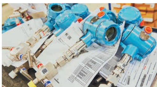
На участке финальной сборки чаще всего встречаются «Метран-150» и более старая, но все еще популярная 55-я модель. Раньше для каждого диапазона давлений изготавливали отдельный прибор. Сейчас в стандартные корпуса просто вставляют соответствующие измерительные модули. Здесь же производственная линия датчиков Rosemount. Готовые приборы калибруют и проверяют повышенным давлением.
