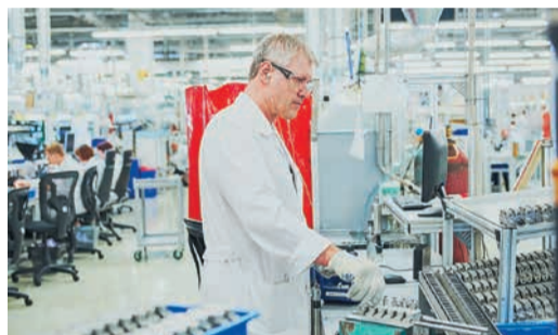
Работа над датчиками «Метран» начинается с изготовления главного элемента — измерительного модуля. Цикл производства составляет около пяти дней: один уходит на сборку и заполнение силиконовым раствором, остальные — на проверку, «тренировку» и тонкую метрологическую настройку. Примерно 50% комплектующих, включая электронные компоненты, поступает из России.
