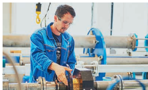
Самое «энергетически чистое» место цеха — проливочная лаборатория. Здесь постоянно бежит вода по пяти испытательным трубопроводам, на которых перед отправкой потребителю осуществляют проверку — «проливают» — жидкостных расходомеров. С этого года впервые в России на предприятии начнут выпускать кориолисовые расходомеры, обеспечивающие корректную работу на трубопроводах любой конфигурации и вне зависимости от направления потока.
