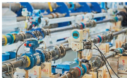
Самое «энергетически чистое» место цеха — проливочная лаборатория. Здесь постоянно бежит вода по пяти испытательным трубопроводам, на которых перед отправкой потребителю осуществляют проверку — «проливают» — жидкостных расходомеров. С этого года впервые в России на предприятии начнут выпускать кориолисовые расходомеры, обеспечивающие корректную работу на трубопроводах любой конфигурации и вне зависимости от направления потока.
