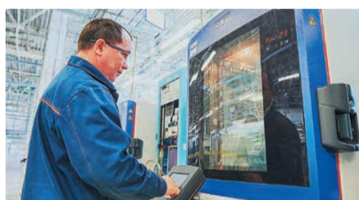
На участке проверки качества регулярно тестируют серийную продукцию, опытные образцы и изделия сторонних производителей. Специальное оборудование позволяет проверить работоспособность приборов в условиях экстремальных температур, повышенной влажности, запыленности и вибрации.
