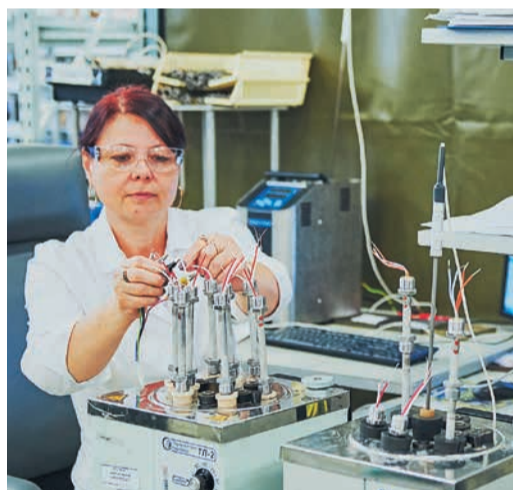
Готовые термозонды проверяют и калибруют в разных условиях, например, нагревая и погружая в лед. Потом прибор окончательно собирают.
