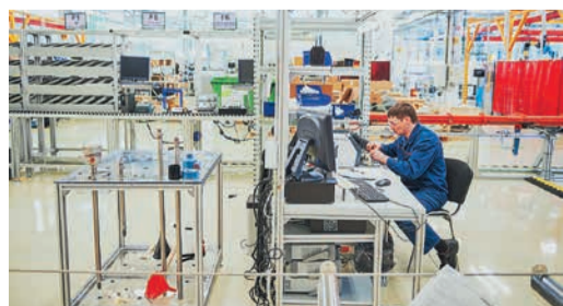
Одно из самых молодых производств — участок изготовления уровнемеров Rosemount для жидкостей и газов. Степень локализации производства около 20%. Для их проверки специалисты предприятия разработали уникальный 50-метровый стенд.
