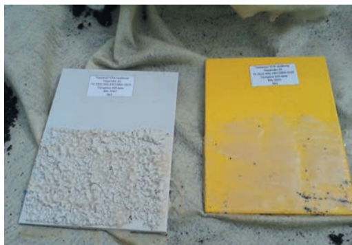
Смывку испытывали на образцах, покрытых разными красками
