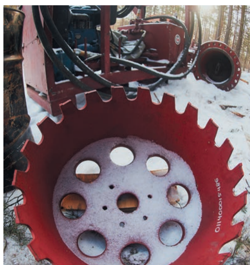
Такой фрезой работники УАВР-1 вскрывают трубу Ду 500
