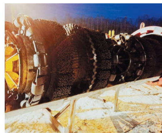
На челябинском старте сцепка из профилемера и «магнита»
