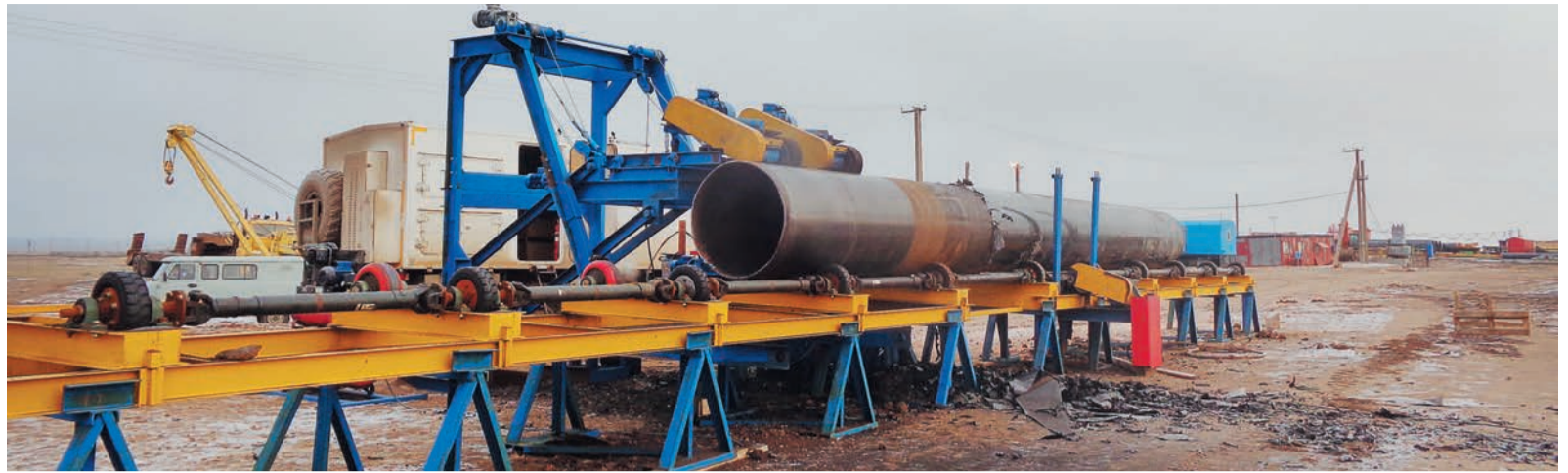
Новая установка может работать с трубами диаметром до 1400 мм
