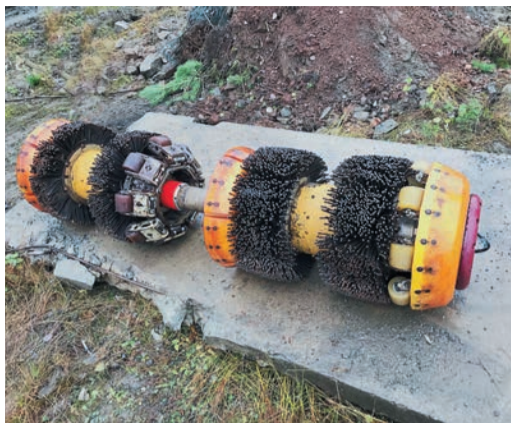
Магнитный поршень завершает очистку трубы перед пропуском дефектоскопа
