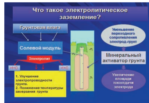
Схема работы электролитического заземления
