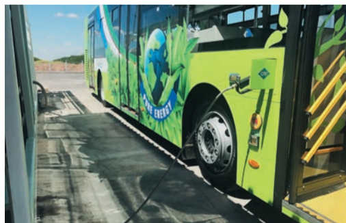
Мобильная КриоАЗС может обслуживать сразу два автобуса, время одной заправки составляет 20 минут
