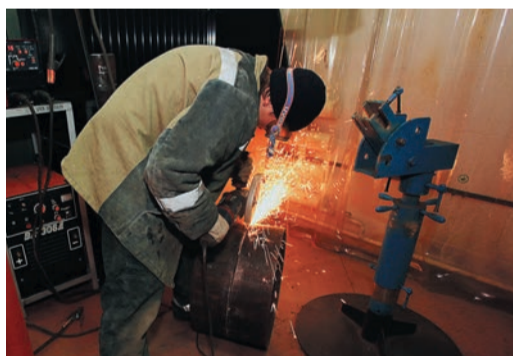
Участники конкурса выполняют все операции по центровке, обработке и сварке катушки
