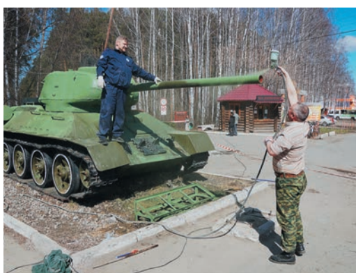
Процесс восстановления техники затянулся на месяц: боевую машину отчистили от грязи, зашкурили корпус, устранили механические повреждения и только затем покрасили
