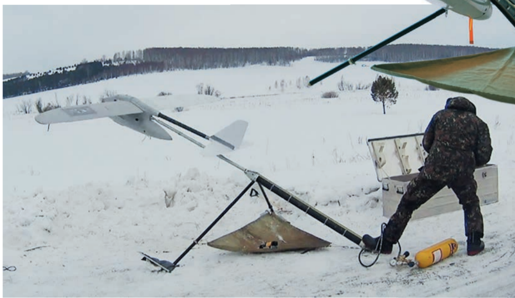
Чтобы не повредить чувствительное оборудование при транспортировке, к месту запуска дрон доставляют в разобранном виде в спецконтейнере
