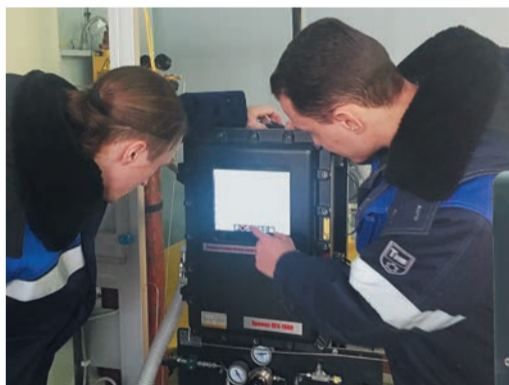
Разделение природного газа на компоненты в ПГХ-1000 происходит достаточно быстро и при незначительных его затратах
