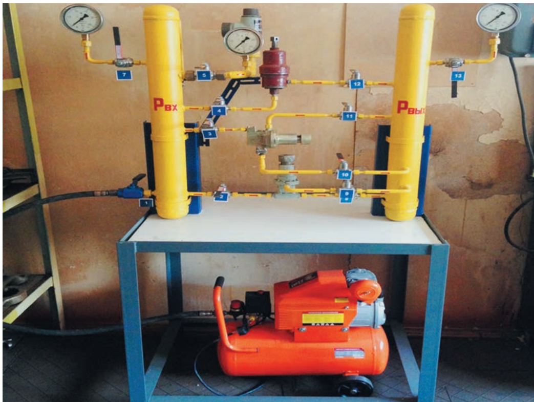
Теперь челябинцы могут испытывать задатчики давления, не расходуя природный газ
