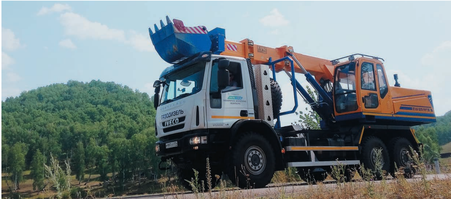
В Оренбургском ЛПУ прошел испытания первый в России газодизельный экскаватор-планировщик
