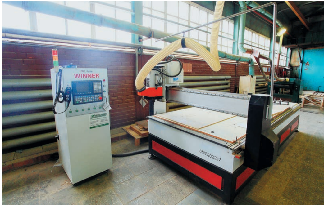
Новый фрезерно-копировальный станок помогает реализовать творческие задумки мебельщиков
