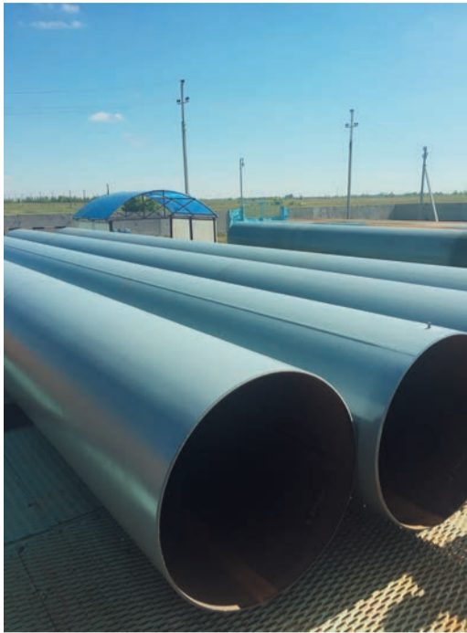
Эпоксидное покрытие охватывает трубу, как перчатка, заполняя все неровности
