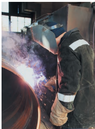
С новой технологией сварщику уже не нужно постоянно менять электроды: его «электрод» — катушка с самозащитной проволокой в подающем устройстве
