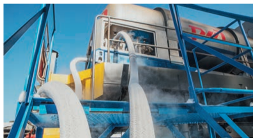
Вот так сотрудники комплекса СПГ под Екатеринбургом заряжают газомоторным топливом выходящие на маршрут инновационные локомотивы
