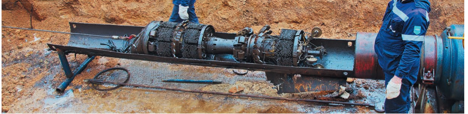
Линтрубы Алексей Топорищев (слева) и Алексей Афанасьев дают «добро» на извлечение дефектоскопа
