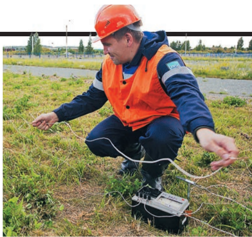
Удельное сопротивление грунта замеряет Дмитрий Кирилов
