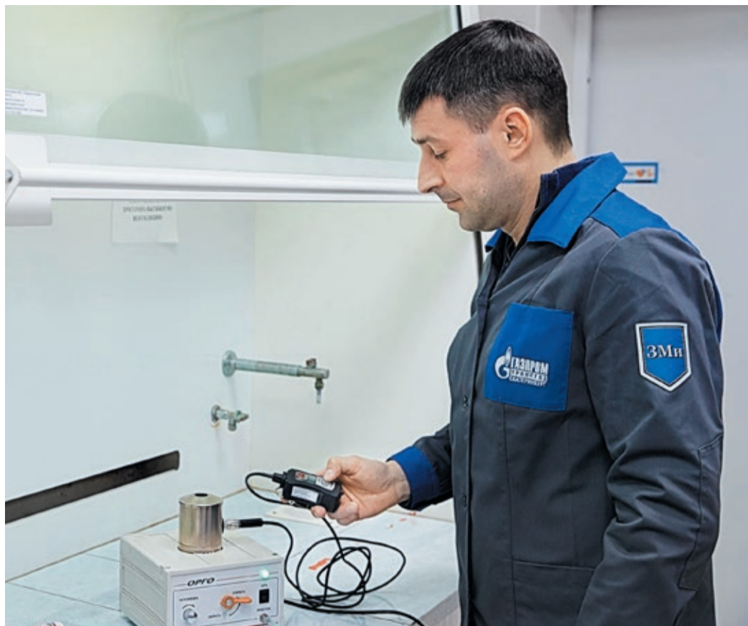
Одориметр выпускает в воздух дозированные порции природного газа, чтобы лаборант смог точно определить степень содержания в нем пахучих веществ
