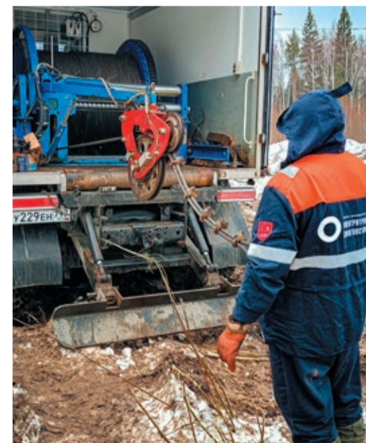
На барабан лебедки намотано больше двух километров стального троса
