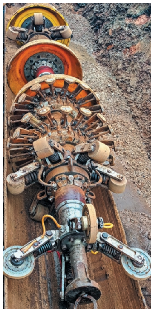
Профилемер помогает обнаружить вмятины и резкие повороты газопровода
