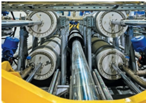
В состав первичного эталона входит модуль эталонов сравнения (слева) и трубо-поршневой пружер с четырьмя цилиндрами
