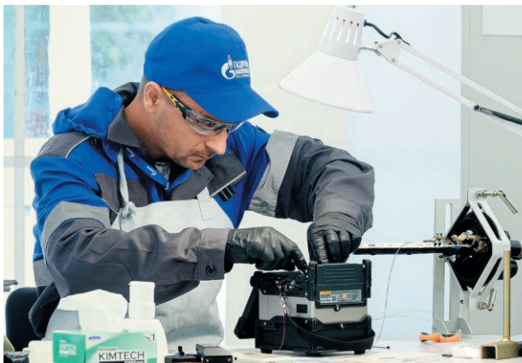
Толщина оптоволоконного кабеля 125 микрон, но Максим Шумилин справился с его сваркой
