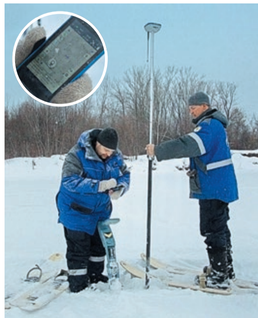
Данные со спутника помогают установить точную глубину дна реки
