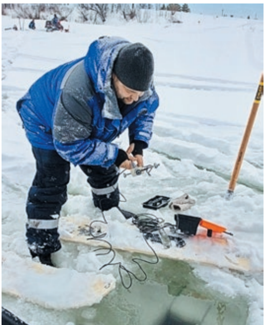
Чтобы узнать скорость течения, под лед опускают «вертушку»
