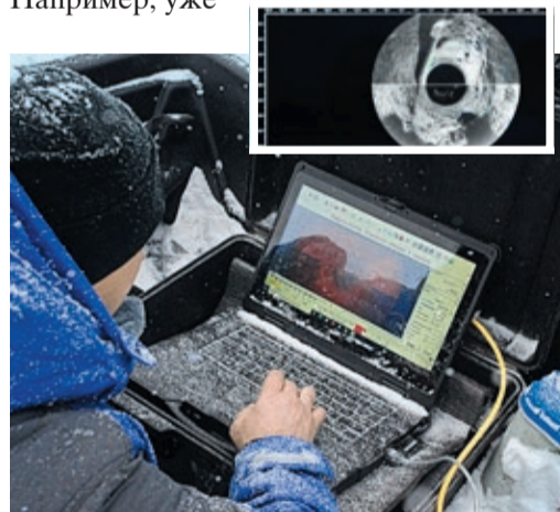
Если дно чистое, гидролокатор дает четкую панораму подводного перехода
